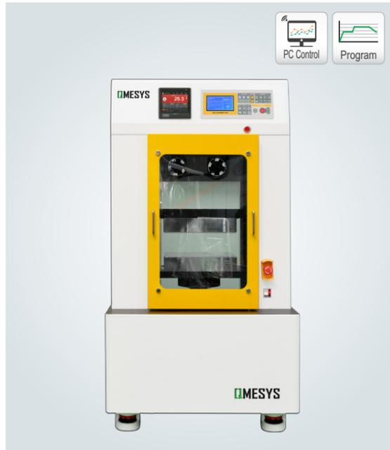
디지털 서보 제어 시스템과 고정밀 로드셀을 적용한 가압 성형 플레이트로 성형 조건에 필요한 하중과 온도 및 압력 주기 등을 자유롭게 프로그램하여 다양한 성형 조건 운전이 가능한 장비이다. 가압 하중 용량의 0.1~100% 전 구간 하중 제어 운전이 가능한 장비로 시험정보와 시험방법의 저장, 불러오기 Raw-Data와 측정 Data 보고서 출력 등 다양한 편의기능을 내장하고 있다. 전용 소프트웨어로 모든 성형 조건에서 얻어지는 온도와 하중 변화를 실시간으로 기록, 측정하고 소재의 멜팅과 성형에서 측정된 Data와 변형 곡선의 기울기를 분석 열에 의한 소성 변형과 탄성 변화도를 평가하고 분석할 수 있는 장비이다.
