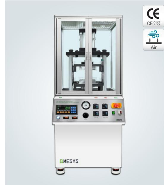
고압 에어 실린더를 적용한 가압 성형 플레이트로 로드셀에 의한 경하중 미세 압력 조절( $\pm 0.1\text{kgf}$ )과 전자식 하중 제어로 얇고 균일한 두께의 시험편 성형에 적합한 장비이다.
